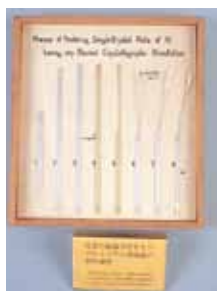
任意の結晶方向をもつアルミニウム単結晶の製作過程 藤原武夫はこの単結晶を用いた研究により第38回日本学士院賞を受賞した。
