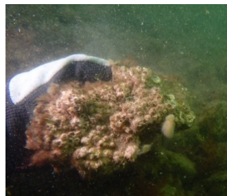
写真4 スラグ上へのフジツボ付着状況
