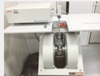
図1 生体試料中のラジカルを測定するための電子スピン共鳴吸収(ESR/EPR)測定装置(日本電子 JES FA-100)。
