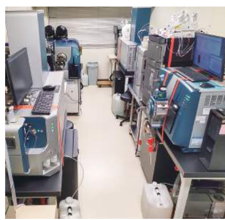
細胞の中で病気のタンパク質の種類と量を決めるための質量分析装置
