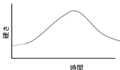
理由: 室温時効 (時間とともに微細析出物が形成して時間とともに硬化, 析出物が出た後 (ピーク時効), 析出物の粗大化, 消失が起こる (過時効).)
