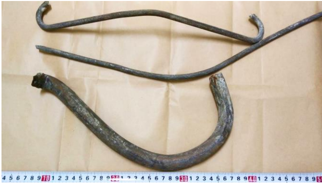
採取された鉄骨（展示します） 丸鋼（細）直径 8mm 丸鋼（太）直径 22mm ※異形鉄筋ではない
