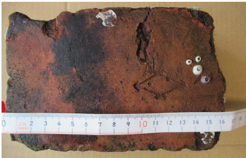
松葉の菱が刻印された被爆レンガ（洗浄後の写真）16 cm×12 cm×8 cm、約 2 kg、
