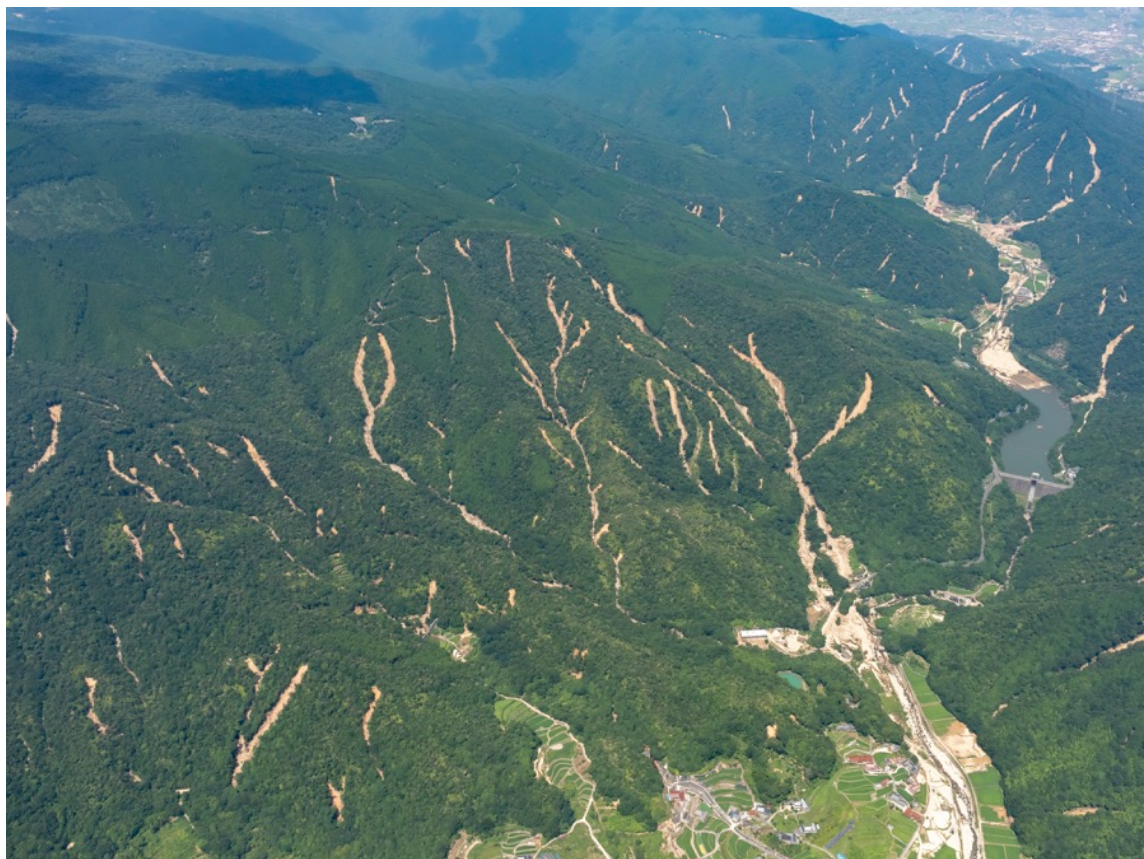
写真1 野呂川ダム周辺の斜面崩壊
