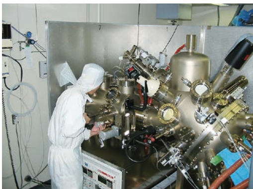
分子線エピタキシー結晶成長装置 Molecular Beam Epitaxial Crystal Growth Facility
