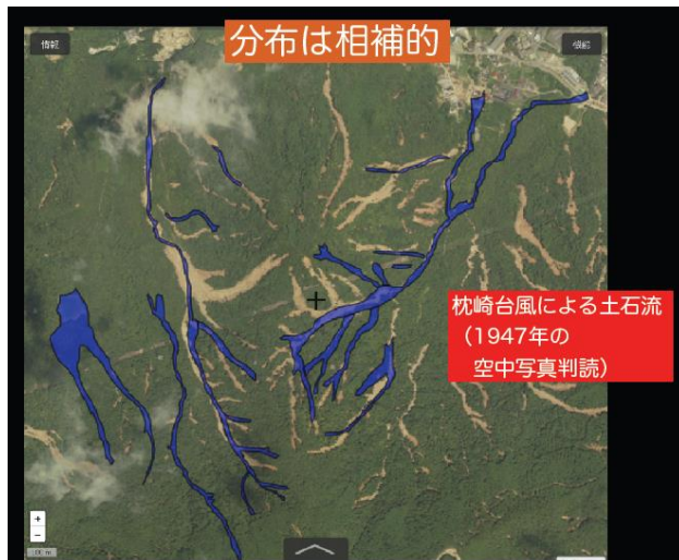
昨年の災害による土石流と枕崎台風（1947）の土石流発生箇所と比較
