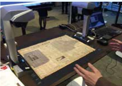
大型サイズの古文書に対しても非接触式スキャナで分割して読み込んだ画像を合成できる古文書電子化技術
