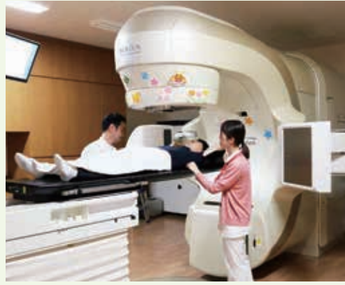
放射線治療 専用の装置を用いて、さまざまな方向からピンポイントで患部に放射線を集中させて照射を行います。照射の方法は、正常組織への影響をできるだけ低減できるように、予めコンピュータを用いて正確に計画されています。
