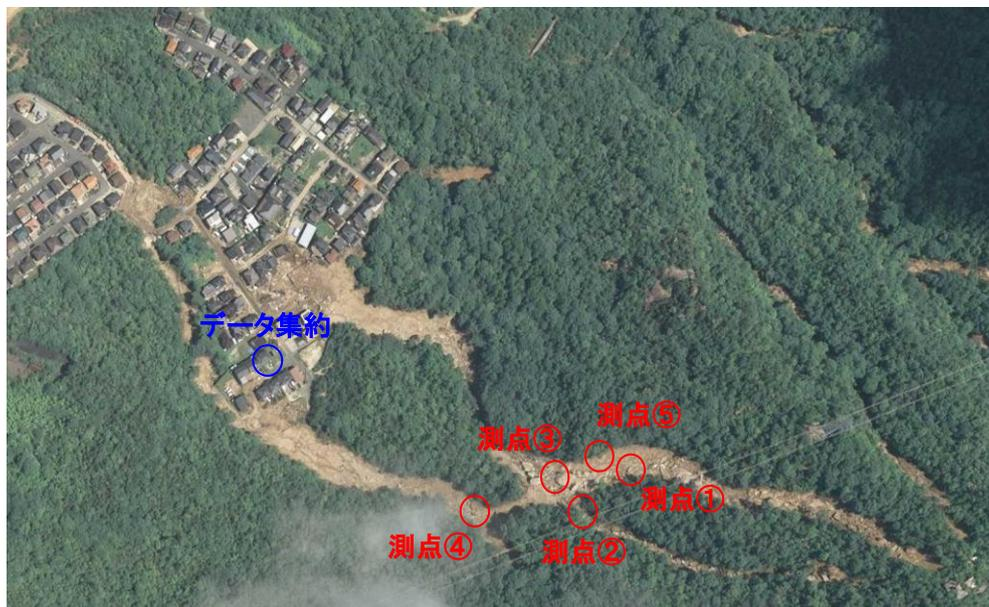
図-1 熊野町川角地区大原ハイツ山側の溪流におけるセンサーの設置位置
