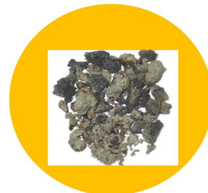
CO<sub>2</sub>吸収石炭灰焼結体
