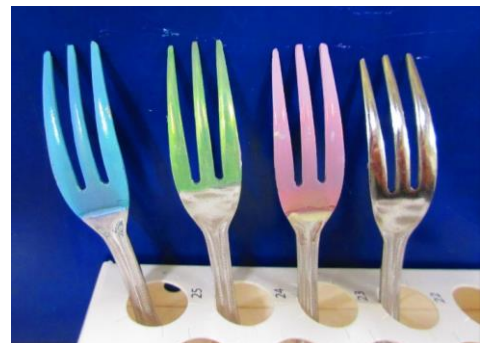
図1 様々なサイズの二酸化ケイ素粒子をもちいたフォーク表面への構造色コーティング（文献1）
