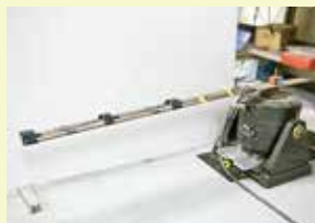
梁の振動試験の様子。
