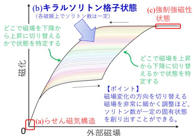
本研究は、最新の高度集積技術を用いてメモリのビット数を増やす方法とは異なり、結晶のキラリティ<sup>4</sup>を利用したアプローチであり、磁場方向を切り替える磁場を微調整させビット数を増やすものです。今後は、極薄試料の作製に加え、意図的に厚みにランダムネスを導入する工程を確立できれば、高度情報社会を支える次世代磁気メモリの容量を無限にすることも可能になります。
