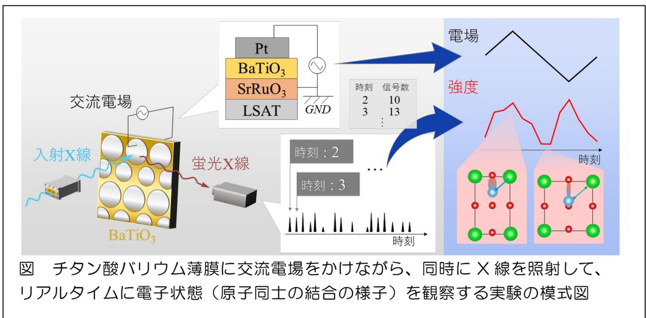
図 チタン酸バリウム薄膜に交流電場をかけながら、同時に X 線を照射して、リアルタイムに電子状態（原子同士の結合の様子）を観察する実験の模式図
