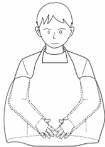
図4：首掛けにより上肢の動きと作業空間を確保した袋状の空間
