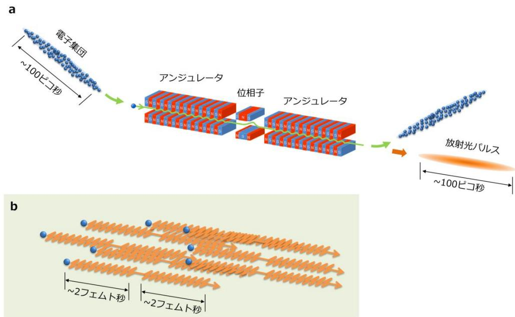
図 1: アンジュレータによる放射光発生の模式図。放射光パルスの時間幅は電子集団の空間拡がりで決まる (a)。放射光パルスには個々の電子が放射した多数の短い波（波束）が含まれている。本研究では二台のアンジュレータを並べて 10 回だけ振動する長さ 2 フェムト秒の波束ペアを生成した (b)。波束ペアの時間間隔は二台のアンジュレータの間にある位相子電磁石で電子の軌道を蛇行させて調整する。
