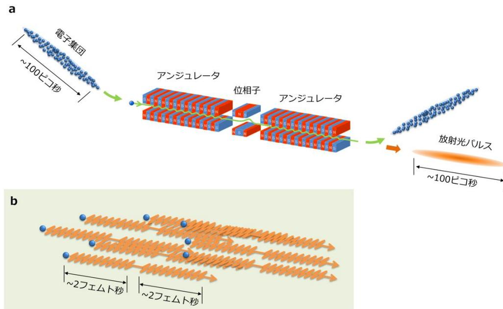
図 1: アンジュレータによる放射光発生の様式図。放射光パルスの時間幅は電子集団の空間広がりによって決まる (a)。放射光パルスには個々の電子が放射した多数の短い波（波束）が含まれている。本研究では二台のアンジュレータを並べて 10 回だけ振動する長さ 2 フェムト秒の波束のペアを生成した (b)。波束ペアの時間間隔は二台のアンジュレータの間にある位相子電磁石で電子の軌道を蛇行させて調整する。
