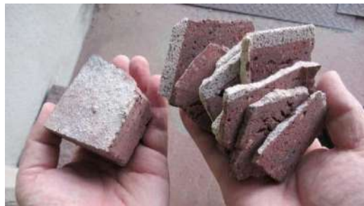
レンガ材の切り取り作業の様子と、約 2 ミリ厚に切り取ったレンガ材（2021 年 5 月 12 日）
