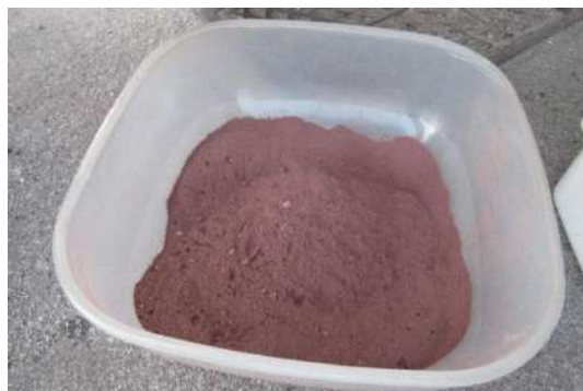
レンガ材切り取り作業の際に出た粉末を集めてフルイに通した状態（2021 年 5 月 12 日）
