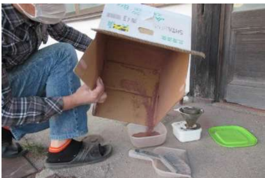
レンガ材切り取り作業の際に出た粉末を集めてフルイに通した状態（2021 年 5 月 12 日）
