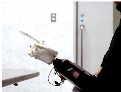
上肢切断患者が筋電義手を操作している様子
