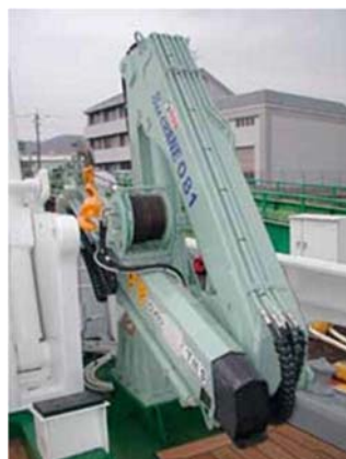
船尾観測クレーン / Aft part survey crane
