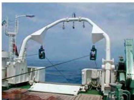
起倒式 A フレーム及び起倒式ランプドア
