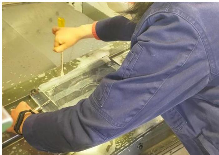
両面テープで加工物を固定してあるため、完成品を外すときにアクリルが割れないよう慎重に作業を行う。
