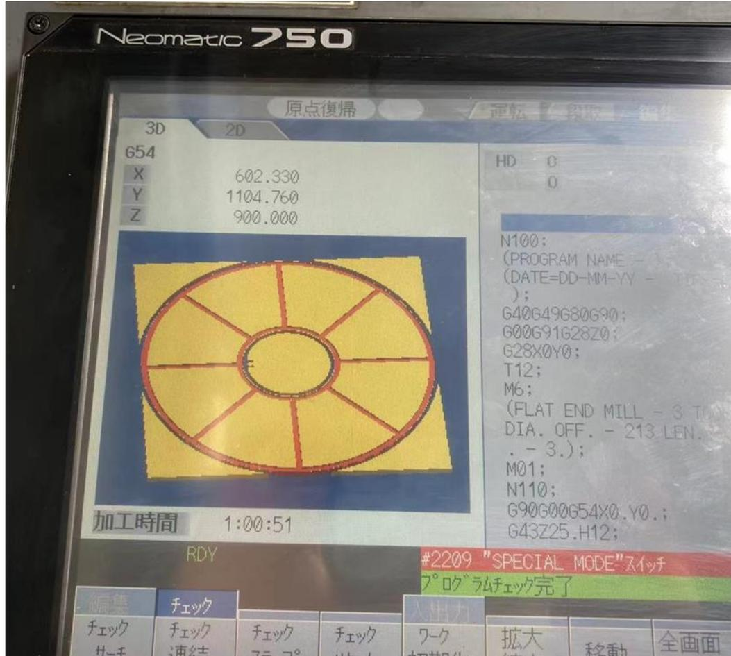
CAMで作成したプログラムをNC機械へインプット
