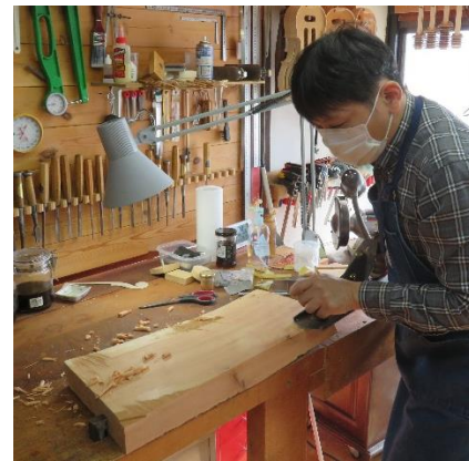
2021年12月ヒロシマエバヤマザクラ製材の様子 鉋(かんな)がけの様子
