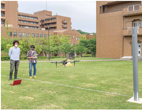
超音波センサを搭載したドローンを用いて、飛行中にボール(障害物)認識テストを行う様子
