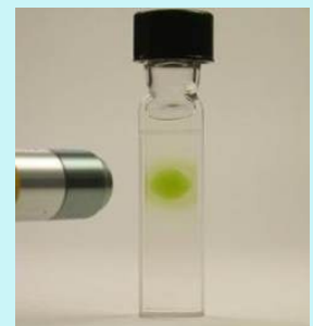
フォトクロミズム例 光により溶液の色が変化
