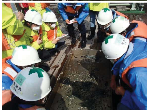
簡易ドレッジ 底生生物を採集する
