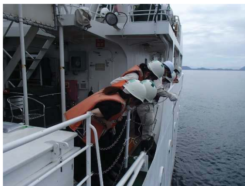
透明度板 円盤が肉眼で何メートルの深さまで見えるかを調べる
