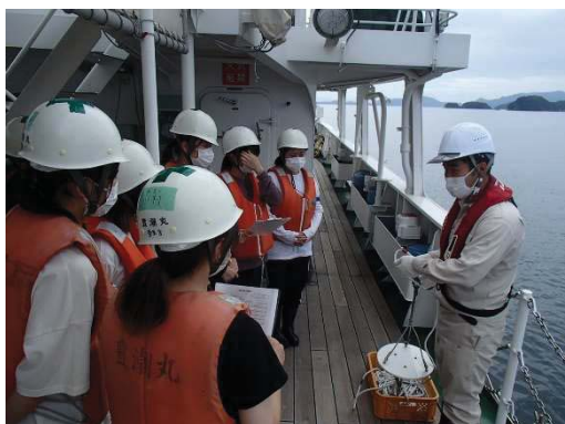
透明度板 円盤が肉眼で何メートルの深さまで見えるかを調べる
