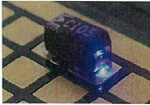
図2. 微小部品（L：1 mm、W：0.5mm）の接合にブルーレーザーで接合
