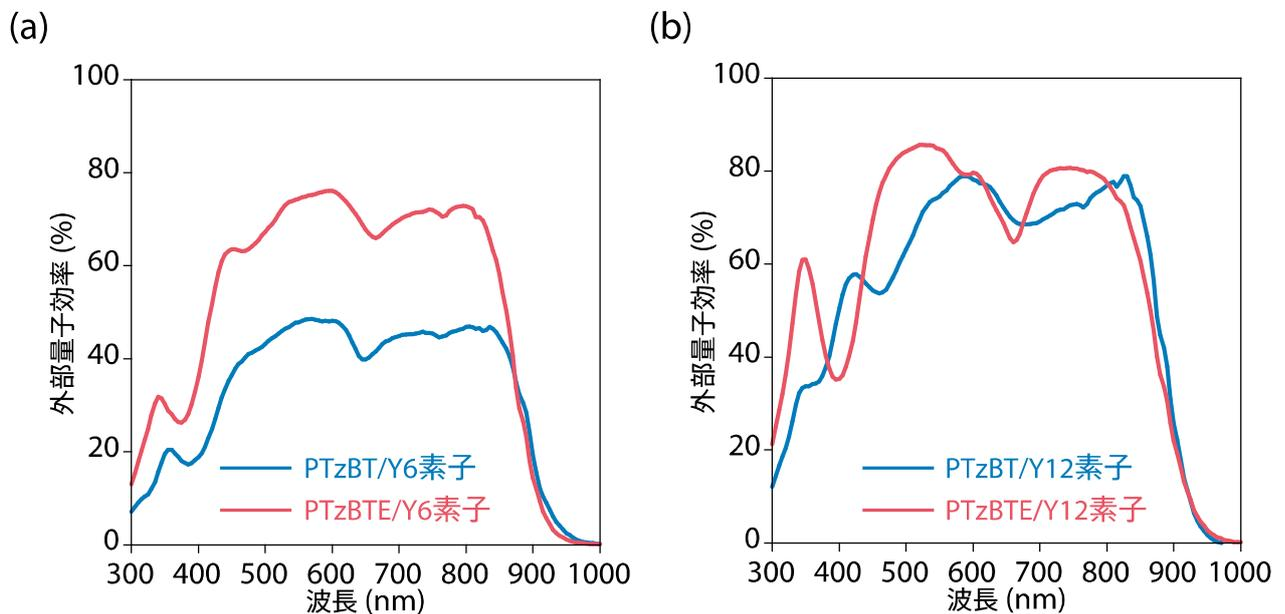
図 2. p 型有機半導体である PTzBT および PTzBTE、n 型有機半導体である Y6 および Y12 をそれぞれ組み合わせた OPV 素子における波長毎の外部量子収率。(a) Y6 を用いた素子、(b) Y12 を用いた素子。Y6 の素子では、PTzBT と PTzBTE で外部量子効率に大きな違いが見られるが、Y12 の素子では PTzBT と PTzBTE は同様に高い外部量子効率を示した。
