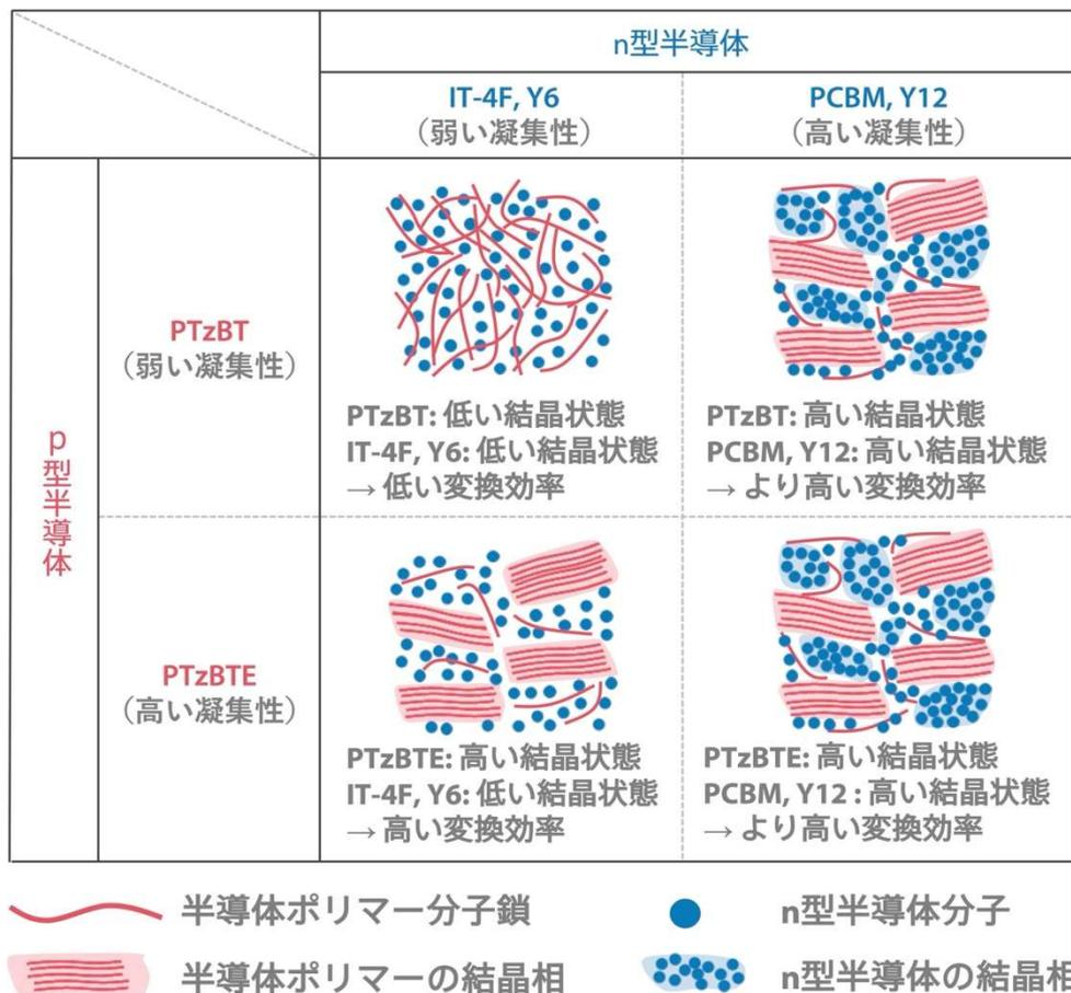
図 3. 凝集性の違いによる混合膜中における有機半導体の結晶状態。p 型有機半導体である半導体ポリマーと n 型有機半導体の凝集性を高めることによって、混合膜はより高い結晶状態を形成し、高い変換効率を得られる。
