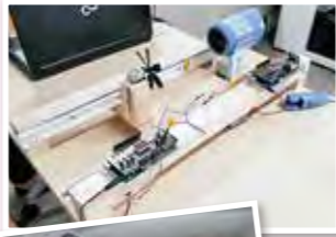
研究室で作った、プロペラの回転速度が一定になるようにドライヤーの風量を制御する装置
