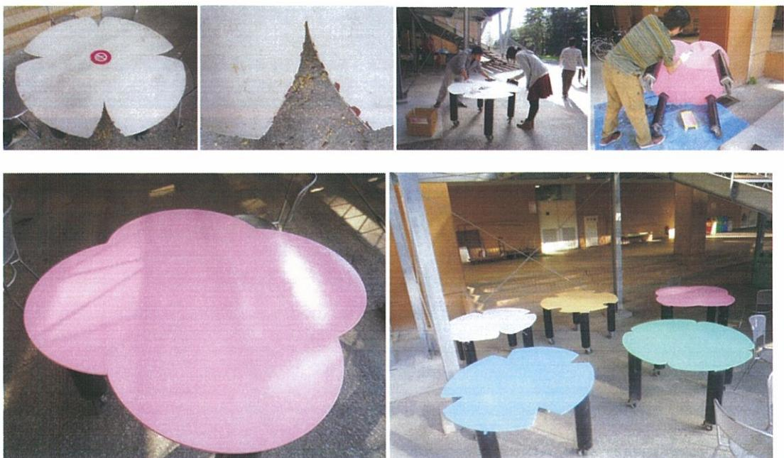
フェニックス工房のものはテーブルの脚の部分がひとつすでに折れており、一応の処理として別の板でつないでいる状態でした。このテーブルは建築学生が設計課題の合間に疲れをいやす場としてよくつかわれており、このままの状態での使用はいつ壊れてもおかしくなく危険でした。修理としては折れている部分の脚を、壊れる前の同じ形の木板と取り換えました。
