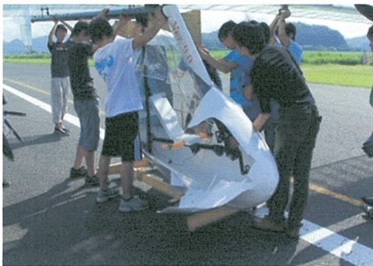
Fig3.損傷したコクピット
