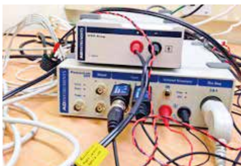
実験に使う発汗などの生理指標を測定する機械。実験に参加している人がドキドキしていることがわかる
