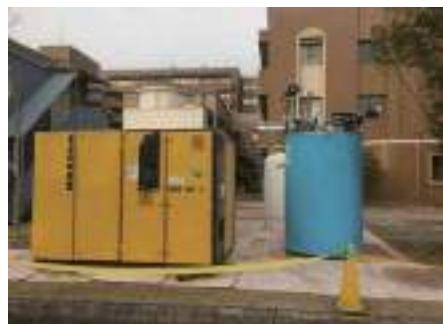
搬出された更新前の液化機、圧縮機、貯槽、クーリングタワー
