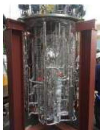
液化機内部の振動防止用振れ止めを外すため、内部配管を抜き出した時の様子。断熱のためのスーパーインシュレーションが巻かれた様々な配管が見える。再度、真空容器の中に入れてしまえば、このような姿を見ることはもう無い。非常に貴重な風景である。
