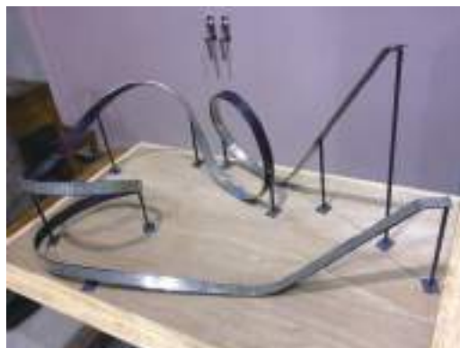
今年度作製した磁気浮上デモ用レール
