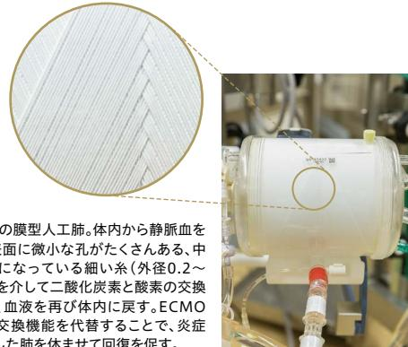
ECMOの膜型人工肺。体内から静脈血を抜き、表面に微小な孔がたくさんある、中が空洞になっている細い糸(外径0.2~0.3mm)を介して二酸化炭素と酸素の交換を行い、血液を再び体内に戻す。ECMOがガス交換機能を代替することで、炎症を起こした肺を休ませて回復を促す。
