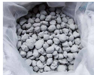
ヘドロが堆積した海底の環境を改善する石灰炭造粒物。
