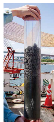
施工後に採取した底泥コアサンプル。
