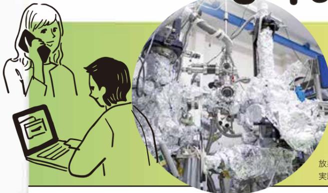
放射光を用いた観測装置。中央の機構にある超高真空環境に実験対象となる物質を入れ、その電子状態を観察する
