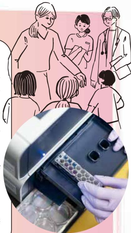
研究で使用する遺伝子導入装置。CRISPR-Cas9で編集した遺伝子を細胞へ注入し、適応を目指す
