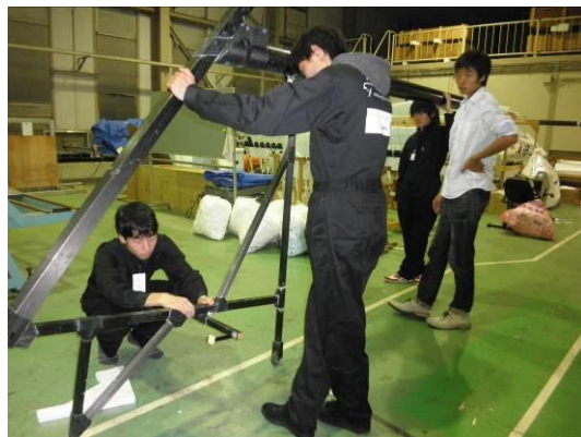
コクピットフレーム製作
