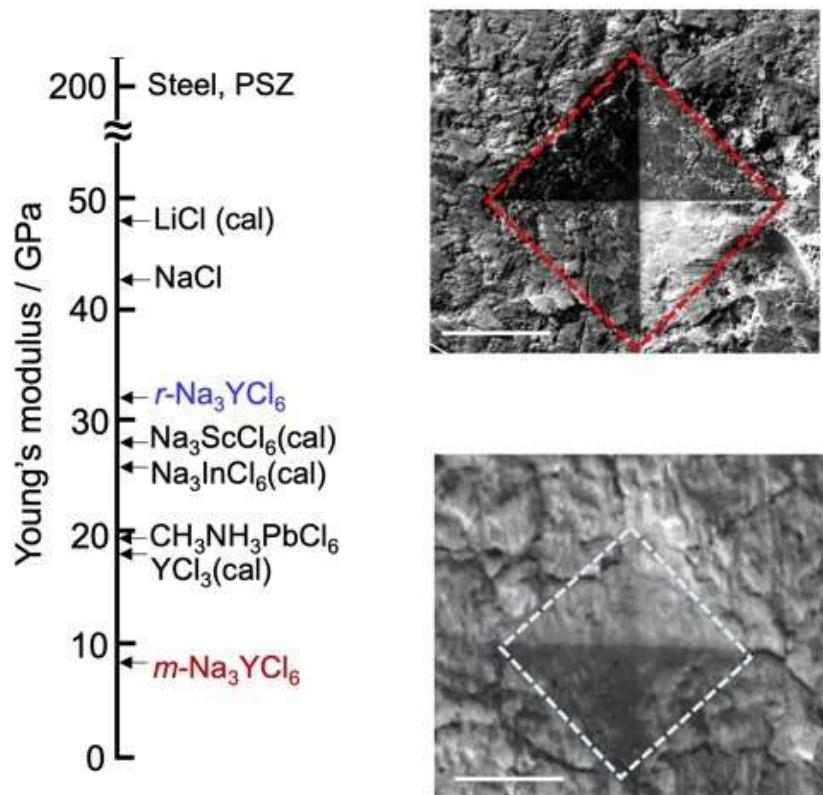
図1. 二種類の  $\text{Na}_3\text{YCl}_6$  ペレットのヤング率と圧痕。m-  $\text{Na}_3\text{YCl}_6$  の大きな圧痕は変形のしやすさを示している。
