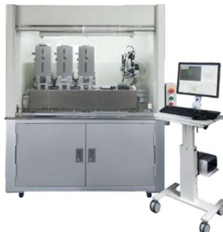
図2 三次元組織を作製するバイオ3Dプリンタ
