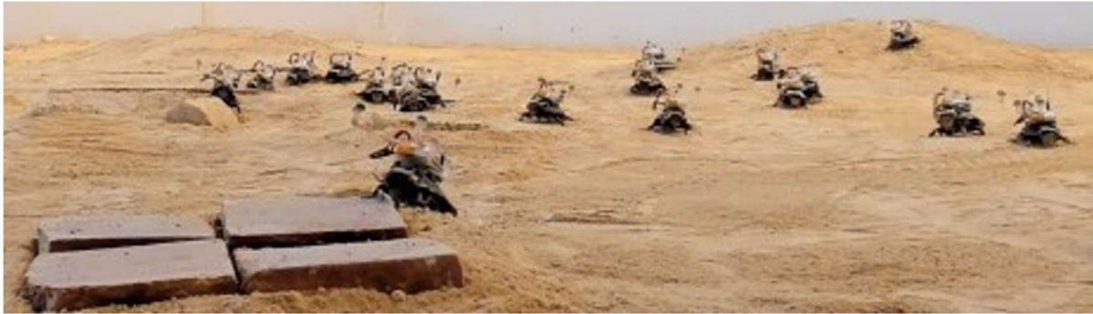
図 2: 実際の実験の様子。手前がリーダーとなるサイボーグ昆虫
