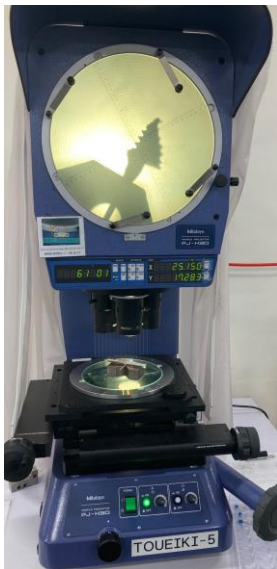
図 5：投影機で角度を測定
