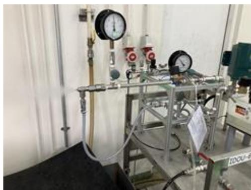
図1 噴霧検査に使用した装置
