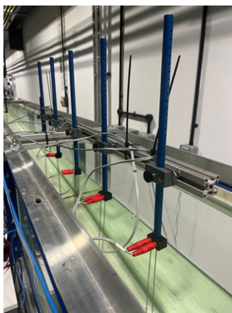
Fig. 1 2次元水槽と波高計
