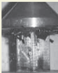
CFRPの落下衝突試験
