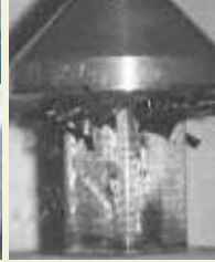
CFRPの落下衝撃試験
